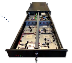
מערכת אספקת חשמל אחודה לארונות - RGX Rackmount Unified Power System
