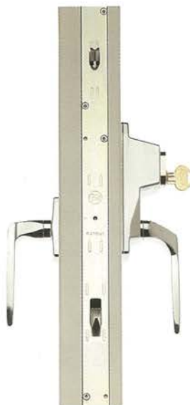
Altandörr utrustad med FIX-säkerhetsspanjolett. De härdade hakkolvarna, tillsammans med kraftiga slutbleck samt säkerhets-handtaget på insidan ger avsevärt ökat inbrottskydd.
