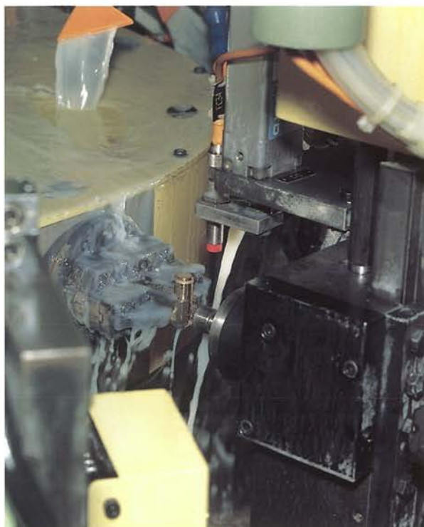
CNC (Computerized numerical control)-styrt maskincenter för produktion av cylinderkärnor.
