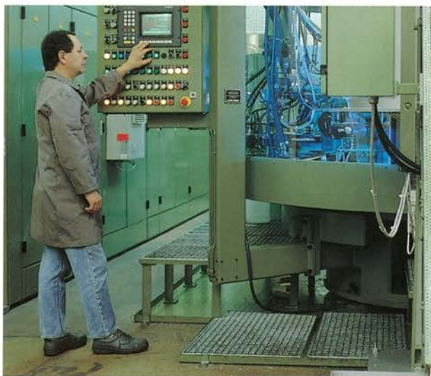
CNC-automat för slutbehandling av cylinderkärnor.
