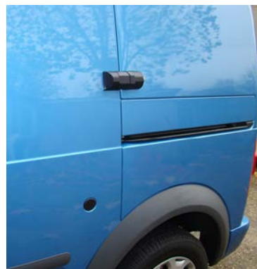
Zajištění bočních dveří dodávkových vozů zámkem MVP2000 pro boční dveře
