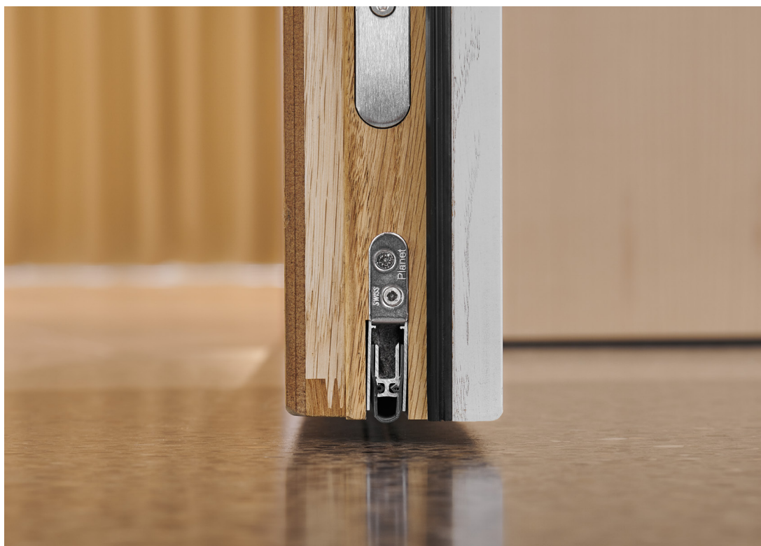
Le joint à abaissement Planet permet de combler l'espace entre le vantail de porte et le sol. L'insonorisation et le climat intérieur s'en trouvent améliorés.
