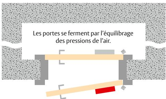
Planet MinE-F/S joint de porte pour l'isolation acoustique, porte coupe-feu et empêche le passage de lumière avec une circulation d'air simultanée
