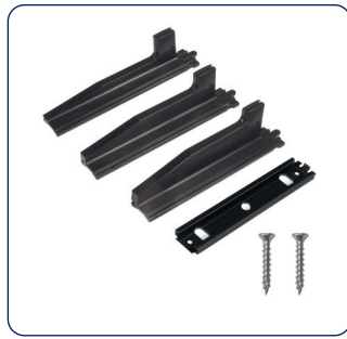
Planet Bodenführungs-Set SN kurz, schwarz: 3 Auflaufkulissen für Bodenluft 7–16 mm und Bodenblech (optional)
