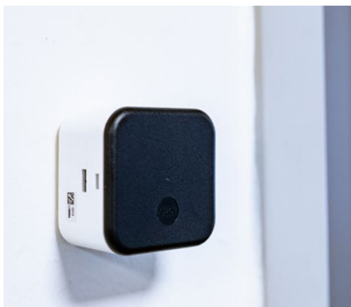
Le contrôleur vous permet de faire fonctionner n'importe quelle serrure électrique ou verrouillage électronique des portes à l'aide d'une application mobile
